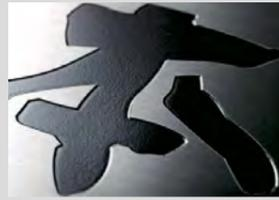
表面を特殊な液体で溶かして凹ませ、そこに塗装を施します。凹み分塗装が厚く塗れるので、ドライエッチングより高級感があります。
