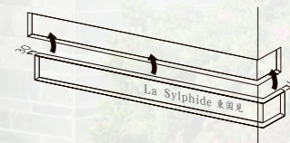
取付面を凹ませたところに接着剤で取り付けます。
