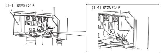
⑤カバーをカチッと音が鳴るように取付け、カバー 固定用ネジを締めてください。
