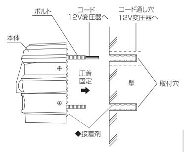
取付シートを壁にあてがいボルト穴・コード通し穴 の位置を決めます。位置がずれないよう注意しなが ら少し大きめの穴を開けきれいに掃除します。ボン ドを注入する前に本体がしっかり取り付くか確認を 行って下さい。コードを通し、ボルト穴にボンドを 注入してボルトを差込みます。ボンドが硬化するま で、固定・防水を必ず行って下さい。
