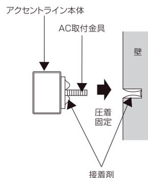
AC取付金具を本体に取り付けます。ボルト位置に合わせ、壁面にボルトの径より少し大きめの穴を開け、きれいに掃除し、穴にボンドを注入してボルトを差込みます。接着剤が硬化するまで固定・防水して下さい。
