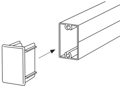
ゴムハンマーなどを使いAC樹脂キャップを押し込んでいきます。(当て布などをしてキャップにキズがつかないように注意して下さい) 樹脂の削れカスを取り除きながら最後までしっかり取り付けます。
