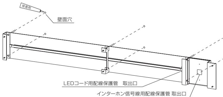
2、壁面に接着剤を入れ込み、圧着固定します。
