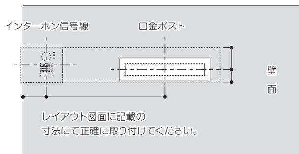
■指定の位置（レイアウト図面参照）に、「インターホン信号線用保護管」と「□金ポスト」を正確に設置してください。
