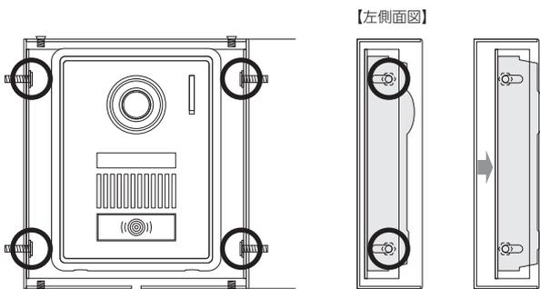
左図の4カ所の六角ボルトを緩めると前後の出幅が調整できます。
