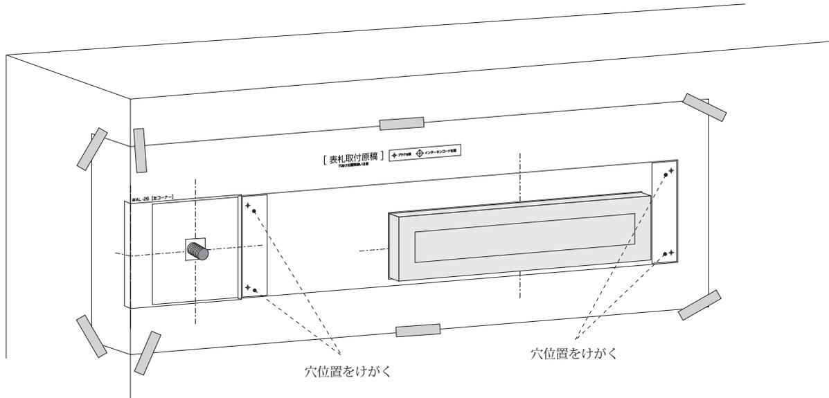
■付属の取付原稿を取付位置に合わせてテープなどで仮止めする、
