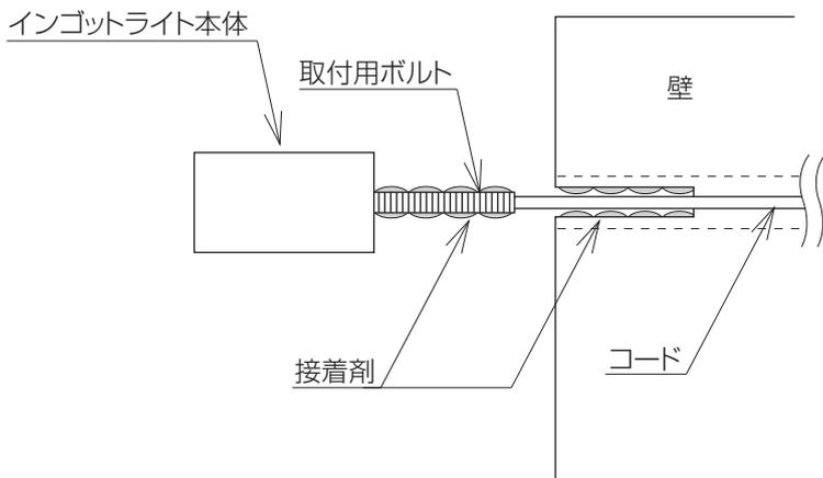
取付用ボルトを本体にねじ込んで取付けます。お買い上げいただいた品番のインゴットライト取付シートを切り取り壁にあてがいボルト穴・コード通し穴の位置を決めます。位置がずれないように注意しながら少し大きめの穴を開けきれいに掃除します。ボンドを注入する前に本体がしっかり取り付くか確認を行ってください。コードを通し、ボルト穴にボンドを注入してボルトを差込みます。ボンドが硬化するまで、固定・防水を必ず行って下さい。
