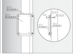
① ポストの位置を決めてから M 4 テックスビスで ② ポスト取付用金具 A とポスト取付用金具 B (ポスト側に同梱) をナットと M4 トラスビスで止めてください。
