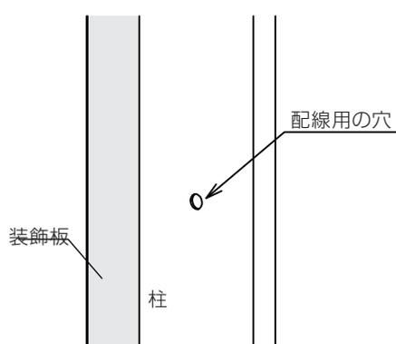
②インターホン取付用のベースをテックスビスで固定し、配線を配線用穴に通してからインターホンを取り付けてください。
