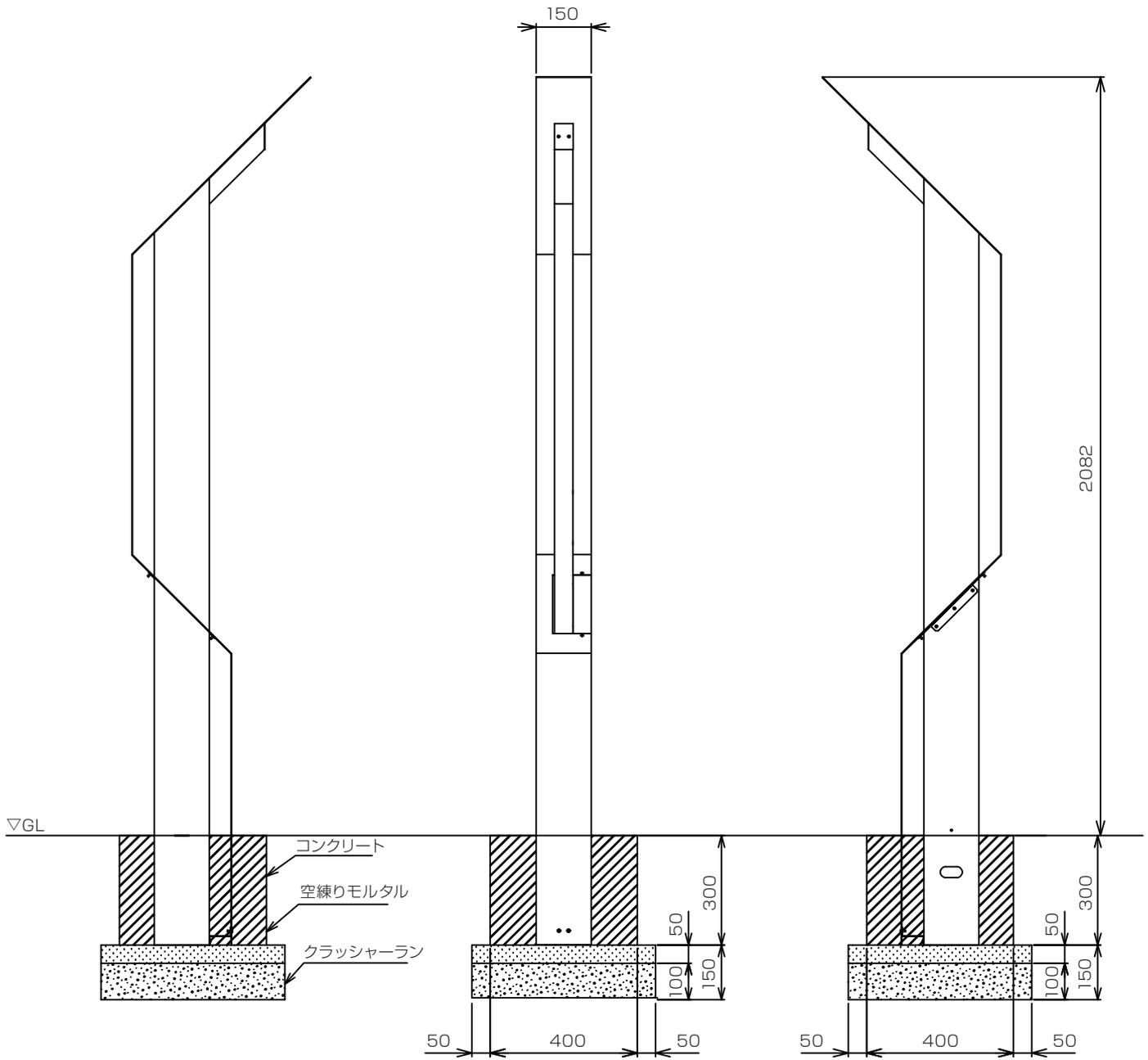
この施工図はあくまでも参考です。現場によって（軟弱地盤など）基礎部コンクリートの埋込み深さ、幅（体積）を十分配慮して取ってください。
