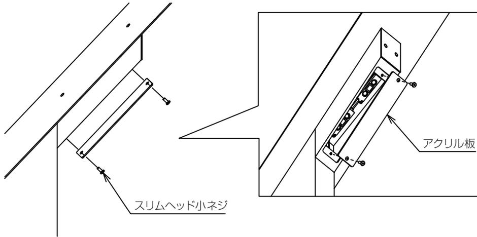
②LED を固定しているネジを取り外し、線を切断してください。
