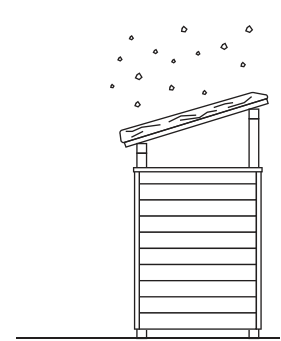
ざらめ雪 溶けた雪が再度凍り、氷の粒が固まった雪(雪比重:0.7) 耐荷重 14cm
