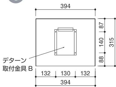
左図のサイズを参考に壁面の取付けたい位置に、ペン等でネジ位置に印をつけます。
