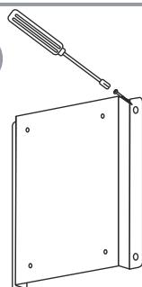
デターン取付金具 B を壁面にナベネジでねじ込み固定します。
