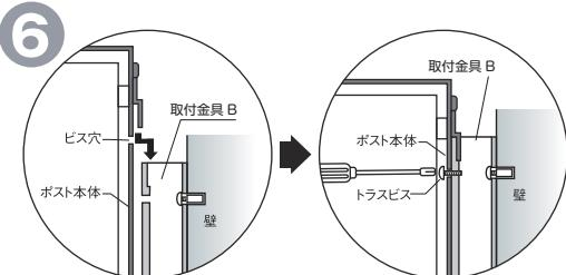
ポスト本体を取付金具 B に引っ掛け、取出口蓋をあけてポストの内側から取付金具 B と本体を付属の M5 ト拉斯ビスで 4箇所固定します。
