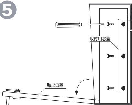
取出口蓋を開けると、奥に取付用窓蓋が付いていますので、そのネジ 6ヶ所を外して取り外して下さい。
