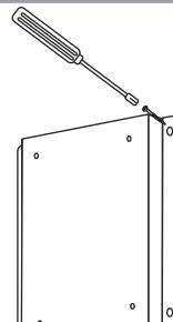
リープ取付金具 B を壁面にナベネジでねじ込み固定します。
