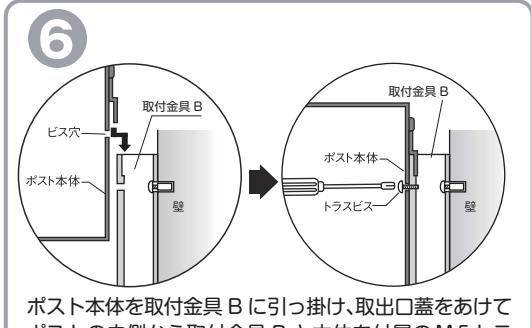
ポスト本体を取付金具 B に引っ掛け、取出口蓋をあけてポストの内側から取付金具 B と本体を付属の M5 ト拉斯ビスで 4箇所固定します。
