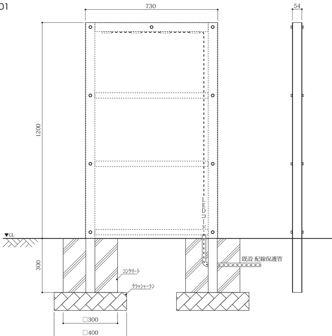
この施工図はあくまでも参考です。現場によって（軟弱地盤など）基礎部コンクリートの埋込み深さ、幅（体積）を十分配慮して取ってください。
