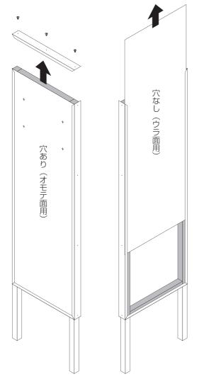
※穴なしの木目パネル(ウラ面用)は、 サイン取付後に組み付けてください。
