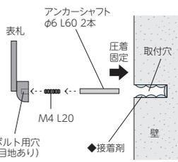
裏側にボルト用の穴が開いていますので付属のボルトを回し込み固定し、アンカーシャフトを回し込んで固定してください。
