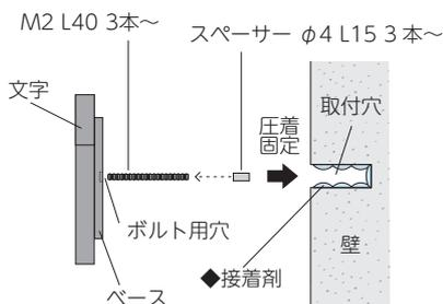
裏側にボルト用の穴が開いていますので付属のボルトを回し込み固定します。
