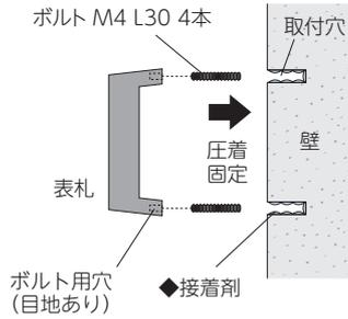
裏側にボルト用の穴が開いていますので付属のボルトを回し込み固定します。
