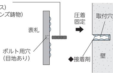
裏側にボルト用の穴が開いていますので付属のボルトを回し込み固定します。
