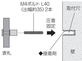
丸ナットに付属のボルトを回し込み、固定します。
