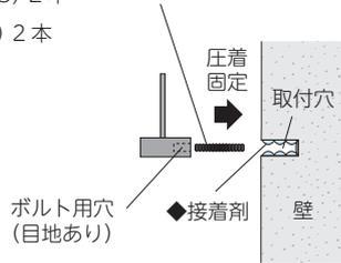
裏側にボルト用の穴が開いていますので付属のボルトを回し込み固定します。
