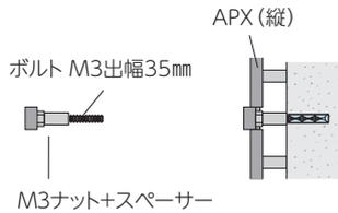
APXはAPX(縦)の溝に、APX(横)をはめ込むように施工をします。
