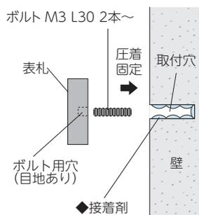
裏側にボルト用の穴が開いていますので付属のボルトを回し込み固定します。
