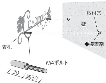
本体の丸管ナットに同梱のボルトを回し込み固定します。
