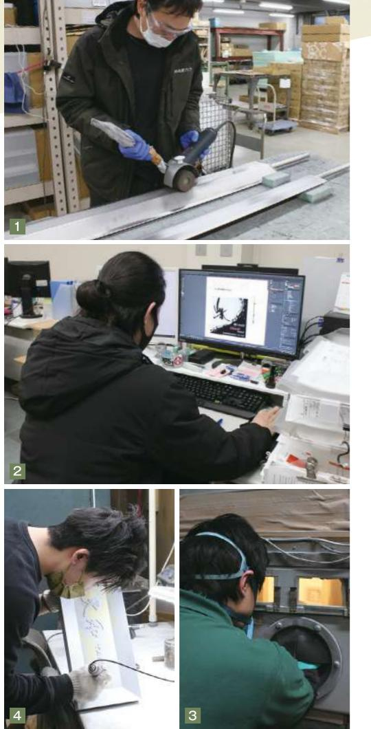
1 「伝説の聖剣」の剣身にはステンレスを使用。磨いてツヤを出してから、戦ったあとに見えるような加工を施していく 2 文字の微調整を行っているレイアウト部 3 職人の経験と技術が生かされるサンドブラスト。素材や文字のかたちに合わせて最適な深さで彫り込んでもいいという 4 仕上げ前の最後の工程。きれいに塗装できるよう、表面のざらつきなどを取り除いていく
